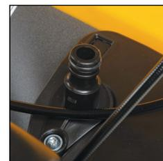
Nützlicher Wasser-schlauchanschluss für schnelles Reinigen des Decks nach Gebrauch.
